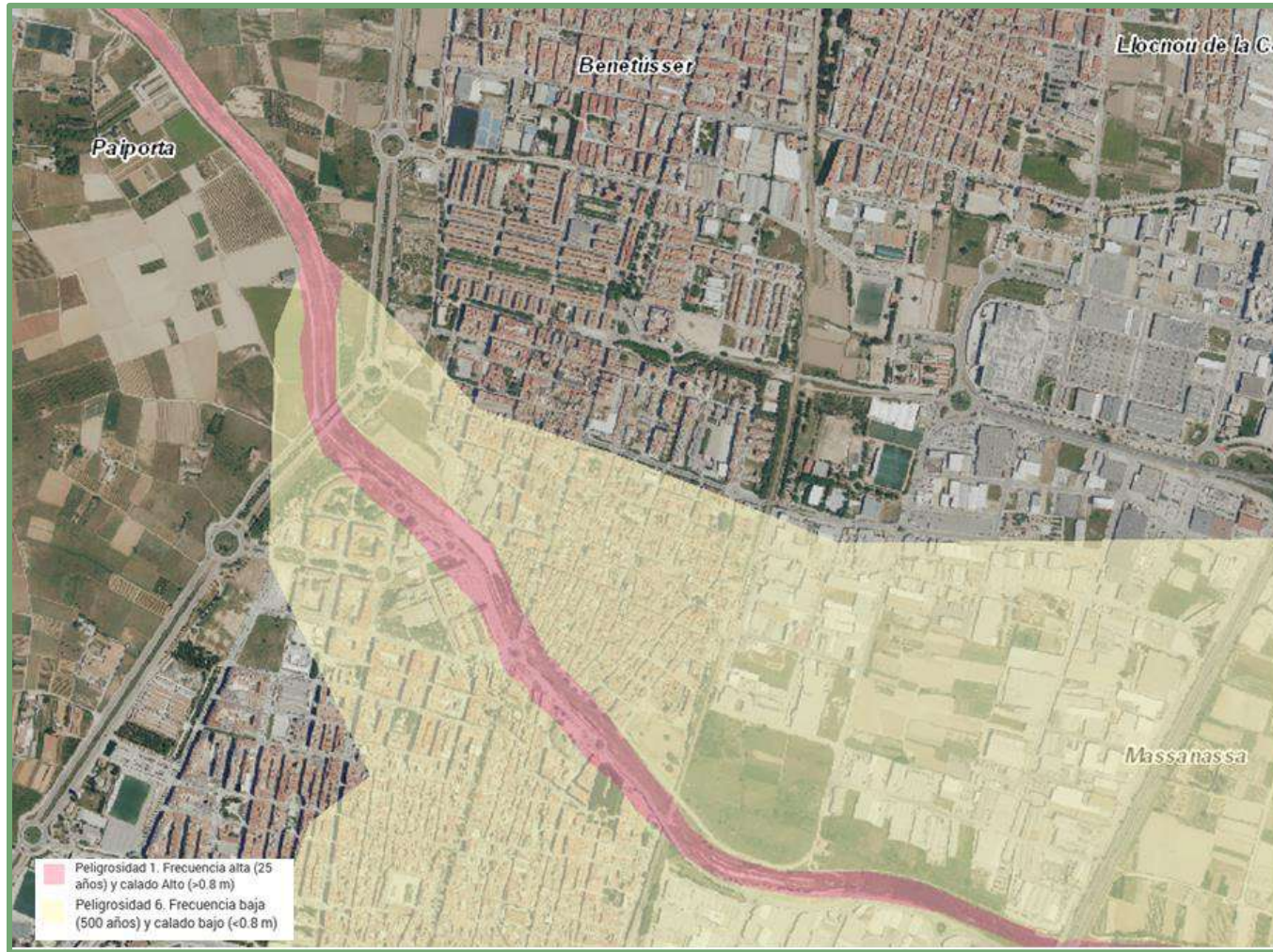
Ilustración 12. Peligrosidad de inundación (PATRICOVA)
